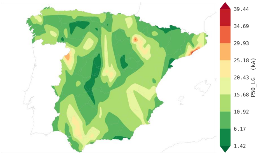
Figura 20. Mapa de curvas de nivel con la distribución de los valores medios de intensidad de cortocircuito monofásico en los nudos de 220 kV
